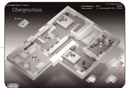
Grundriss eines Stockwerks: rote Balken signalisieren geöffnete Fenster
